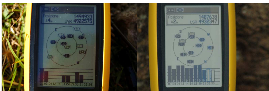
Garmin C60: particolare della schermata principale con indicazione dei satelliti rilevati. Si noti la precisione - figura di destra - che con la correzione differenziale Waas/Egnos arriva a 2 mt.
